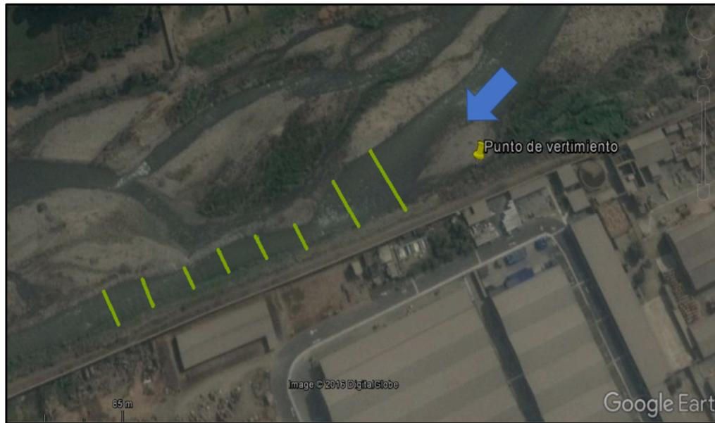
**Figura 11.** Determinación de  $W_{\min}$  para la sección del río Rímac (Google Earth, 2016).
