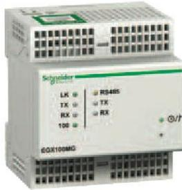
Las pasarelas Ethernet EGX 100 y EGX 300 de PowerLogic, son la conexión directa a las redes Ethernet de alta velocidad. Permiten compartir los datos entre varios usuarios, pueden ser dedicados al control o cumplir múltiples funciones de monitoreo y supervisión. Esta solución garantiza la adaptación serial ModBus RTU (RS-485) / ModBus Ethernet TCP/IP.
