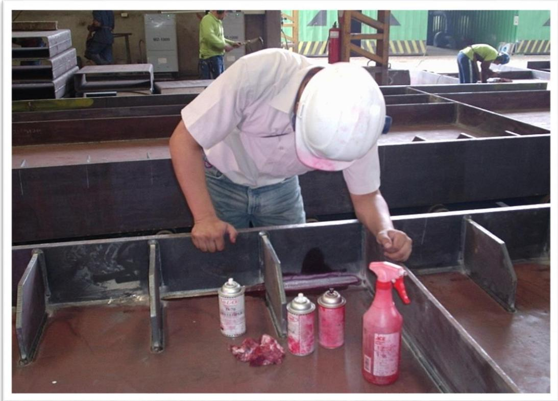
Ensayos de líquidos penetrantes a una columna.
