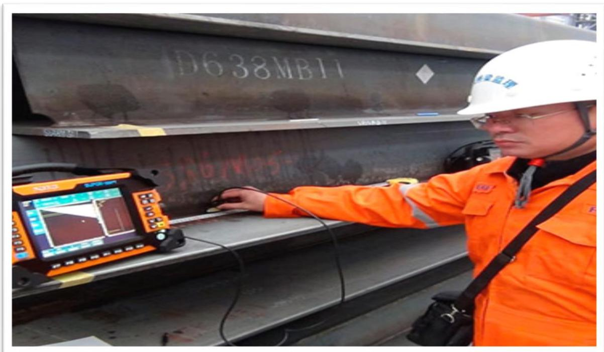
Ensayos por ultrasonidos a unas vigas.
