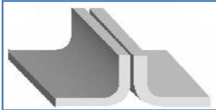
FIGURA N° 09: JUNTA DE BORDE
