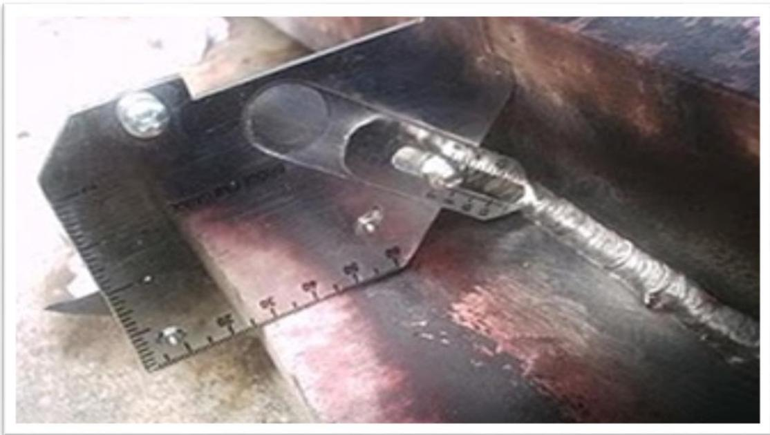
**Instrumento de medición para los catetos del cordón de soldadura.
