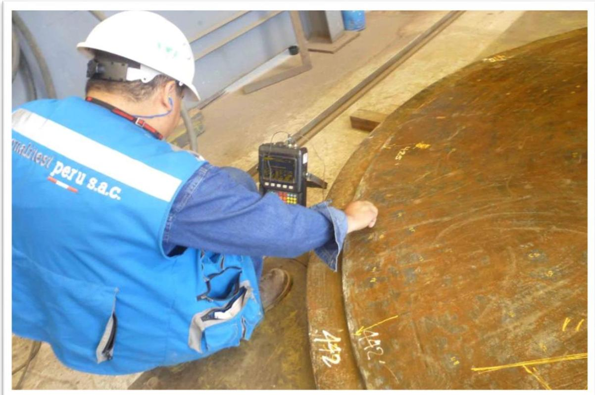
Ensayos por ultrasonidos a una placa de estructura metálica.
