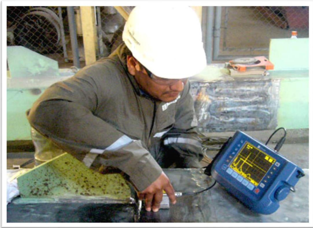
**Ensayo de ultrasonidos a una columna.**
