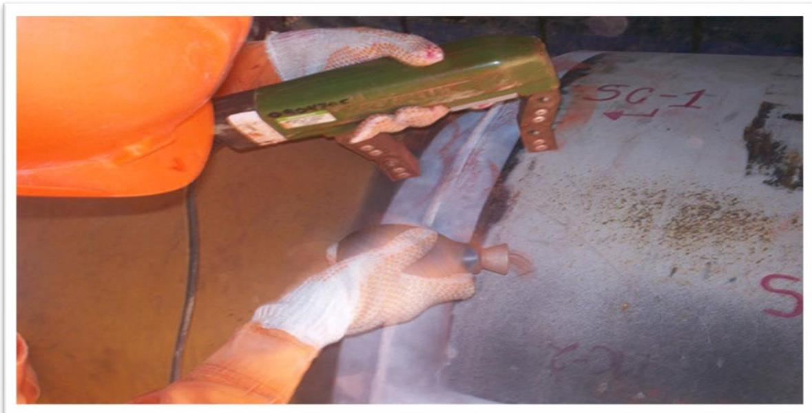
Ensayos de partículas magnéticas cilindro metálico.
