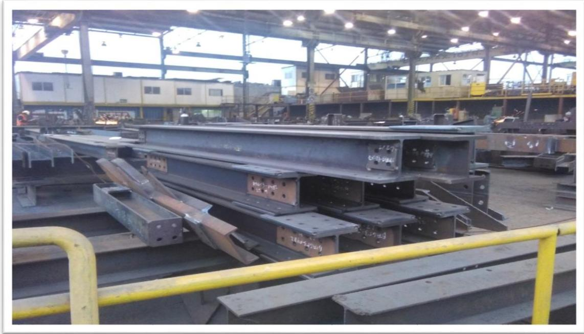
**LAS ESTRUCTURAS METALICAS (VIGAS), LISTA PARA SER LLEVADAS ALA AREA DE PINTURA Y SER INSPECCIONADAS.**
