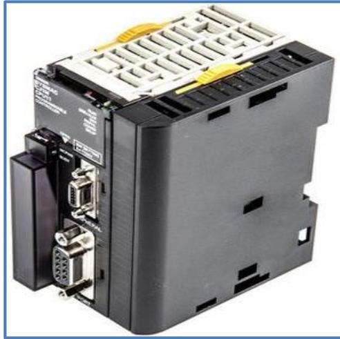
**Figura N° 02:** Unidad central de procesos (CPU) del PLC
