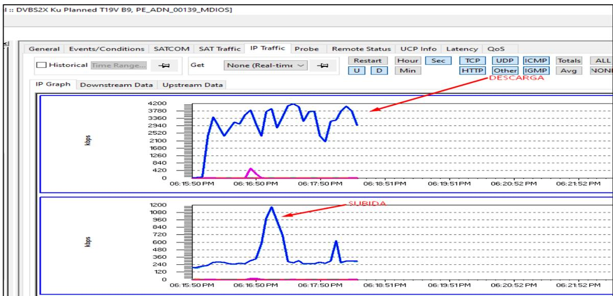
Figura 59: Saturación de red mediante la plataforma iMonitor.
