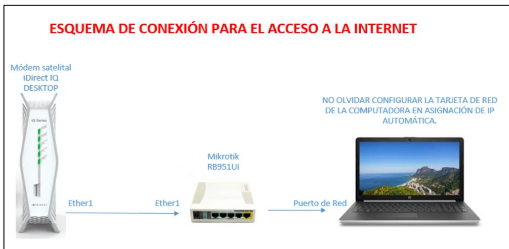
Figura 44: Conexión entre el módem iDirect IQ y el router Mikrotik RB951Ui para el acceso a la Internet.
