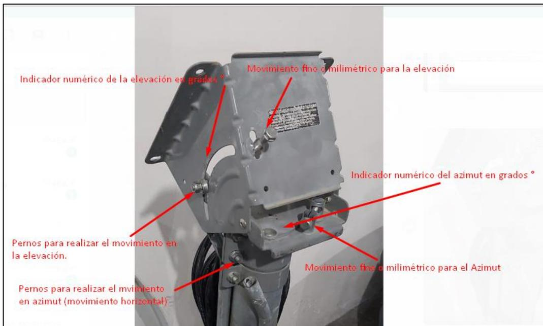
Figura 21: Canister para antena VSAT Banda Ku, 1.2 mts.
