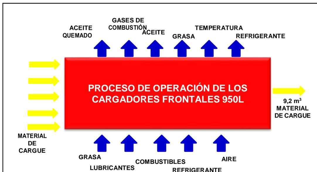
**Figura 13:** Diagrama de entradas y salidas del proceso de operación de los cargadores frontales 950L
