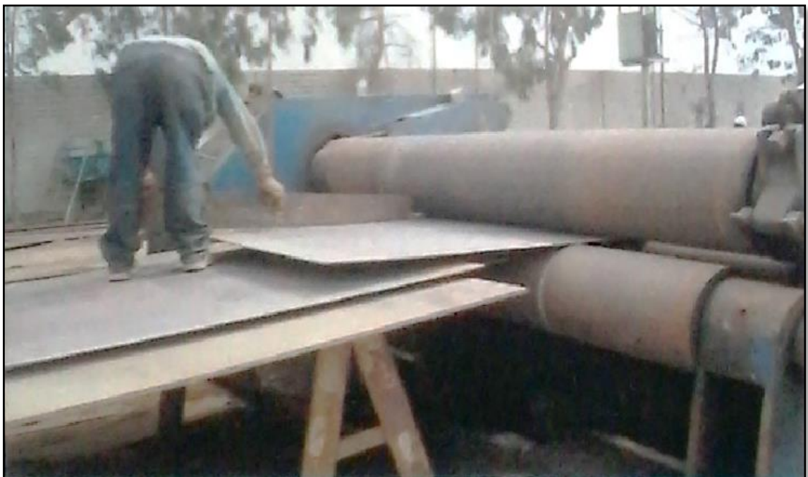
Figura 3.13 Rolado de planchas.
