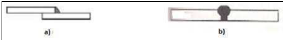
Figura 2.2. Representación de las uniones soldadas más comunes en tanques de almacenamiento a) Soldadura de Filete, b) Soldadura a Tope o ranura.
