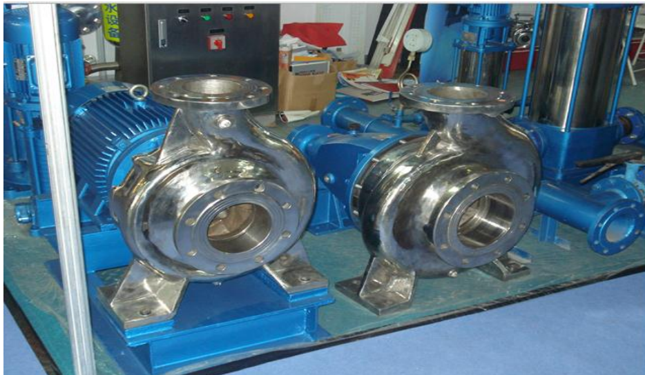
Figura N°19: Bomba Drotec de acero inoxidable interno
