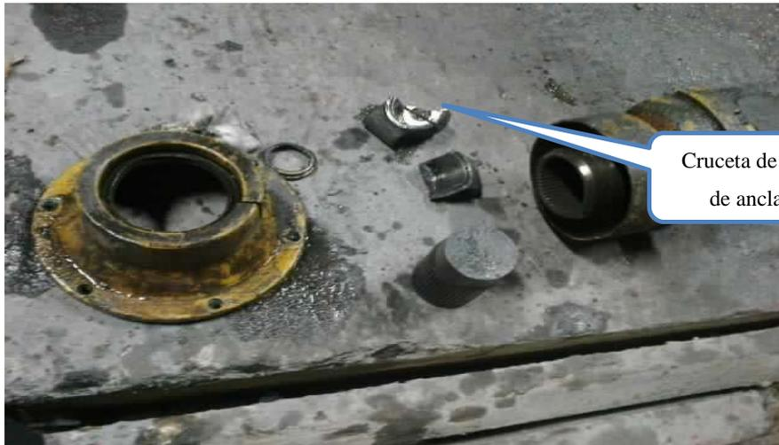
Cruceta de cardan y pernos de anclaje con rotura
