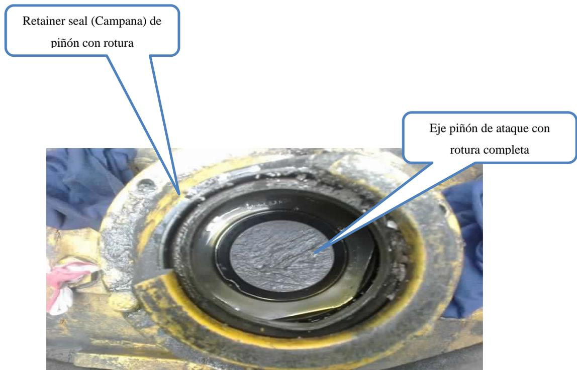
Cabe señalar que este tipo de rotura del piñón, podría deberse a una fatiga del material, por las horas de trabajo y a los esfuerzos a que está sometido este componente, en forma constante, cuando está en operación.
