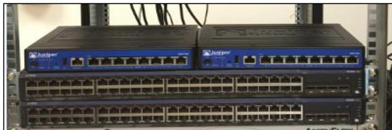
**Figura 3.48.- Equipo juniper instalado en el laboratorio donde se realizaron pruebas de armado de virtual chassis. Elaboración propia**
