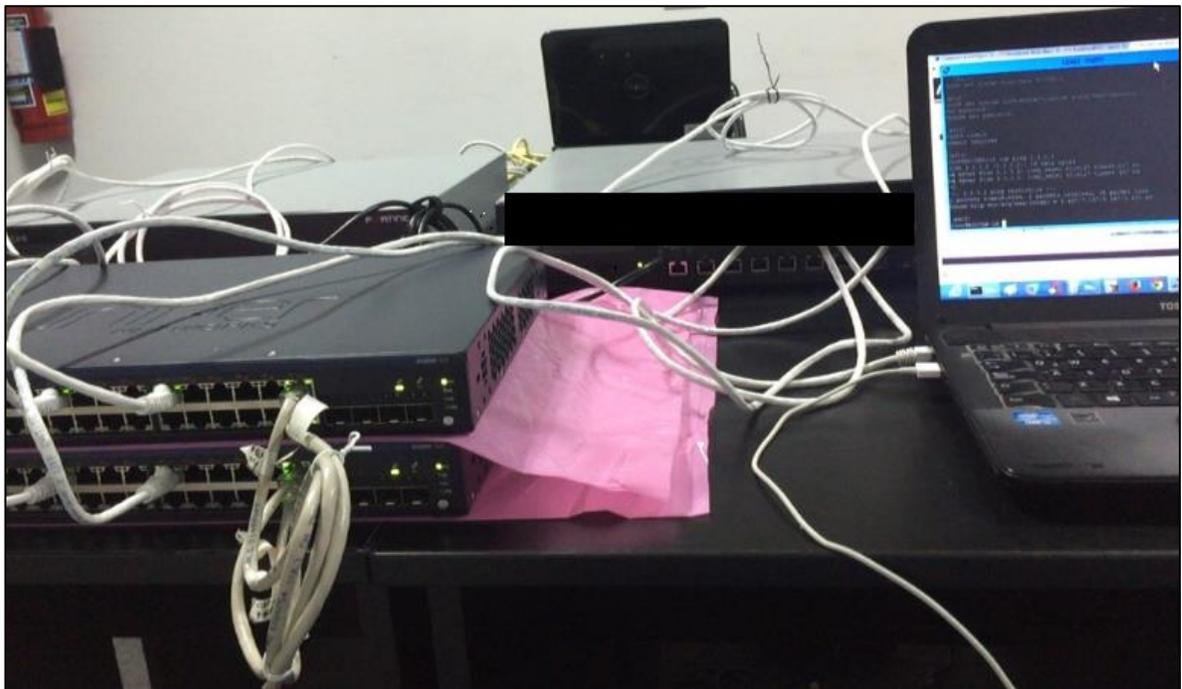
**Figura 3.56.- Pruebas de laboratorio y las conexiones de los equipos juniper mediante cable consola para ingresar al modo de configuración. Elaboración propia.**
