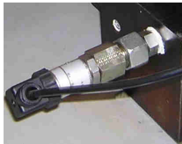
Figura N° 6. Transmisor de presión
